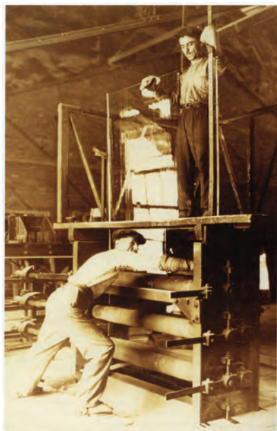
Ανάσυρση υαλοπίνακα με τη μέθοδο Fourcault
